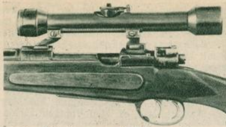
Suhler Befestigungsart mit Zeiß-Patentklemme.
