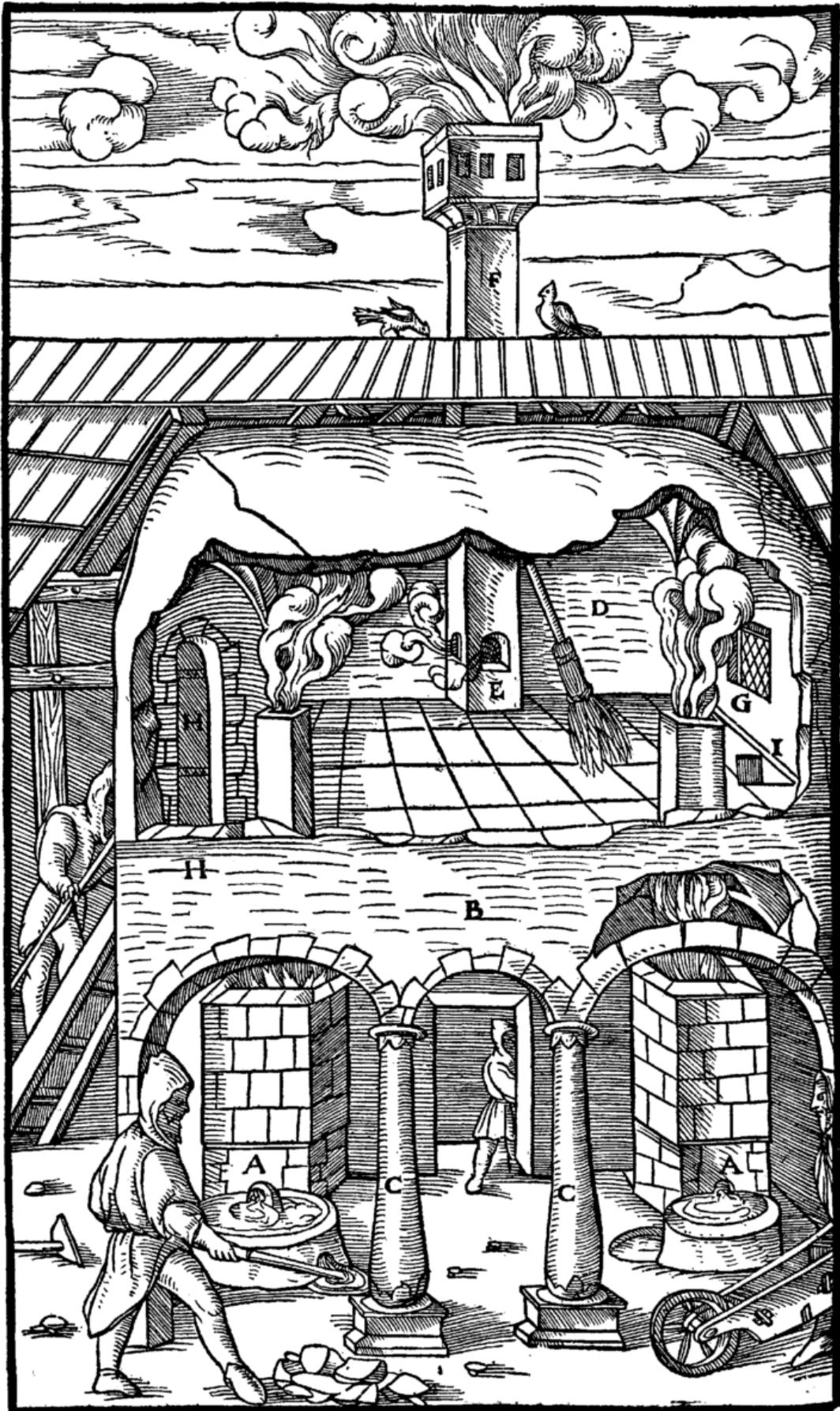
Die Öfen A. Das Gewölbe B. Die Pfeiler C. Die Flugstaubkammer D. Die Öffnung E.
