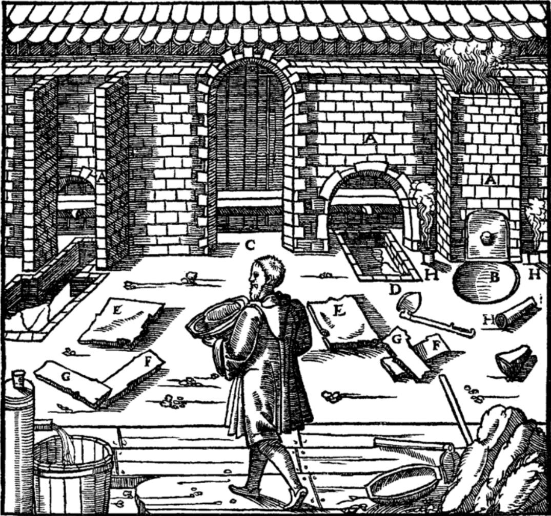
Die Schmelzöfen A. Der Vorherd B. Die Thür C. Der versenkte Feuchtigkeitsbehälter D. Platte zum Bedecken desfelben E. Gemauerter Kanal F. Platten zum Bedecken desfelben G. Rohr, durch das die Dämpfe entweichen H.
