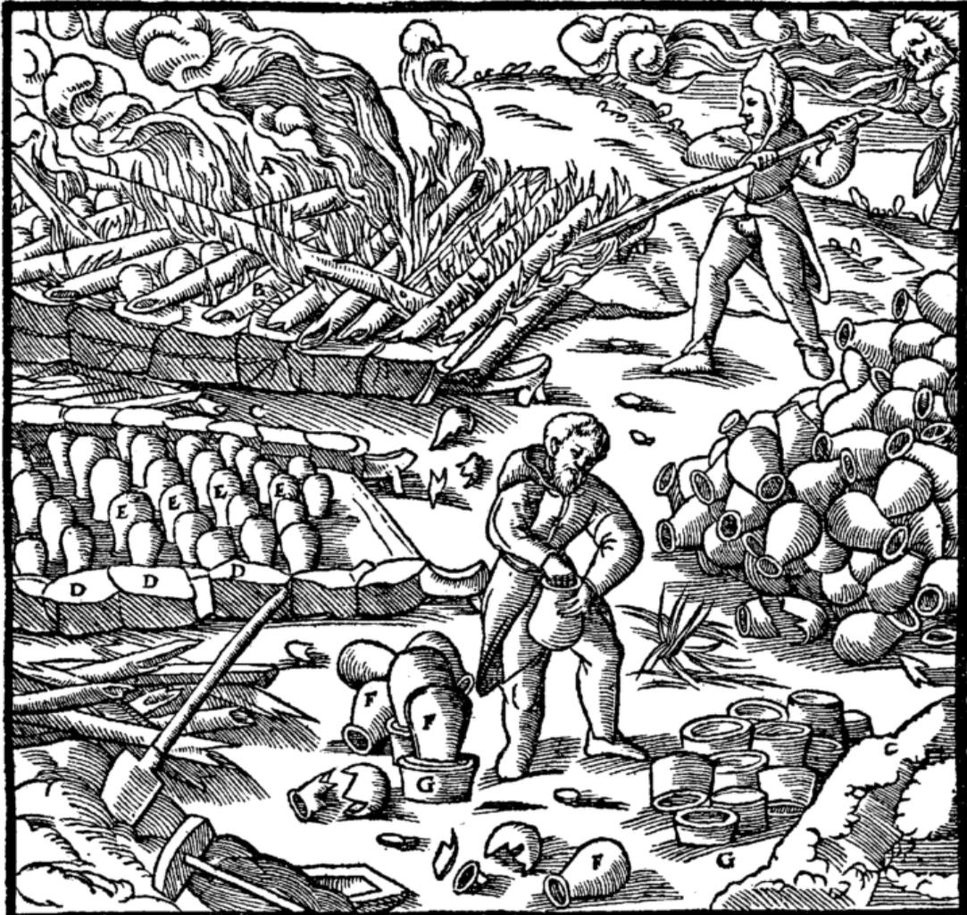
Die brennende Feuerstätte A. Die Hölzer B. Die nicht brennende Feuerstätte, in welche die Töpfe eingesetzt werden C. Die Steine D. Die Topfreiher E. Die oberen Töpfe F. Die unteren Töpfe G.
