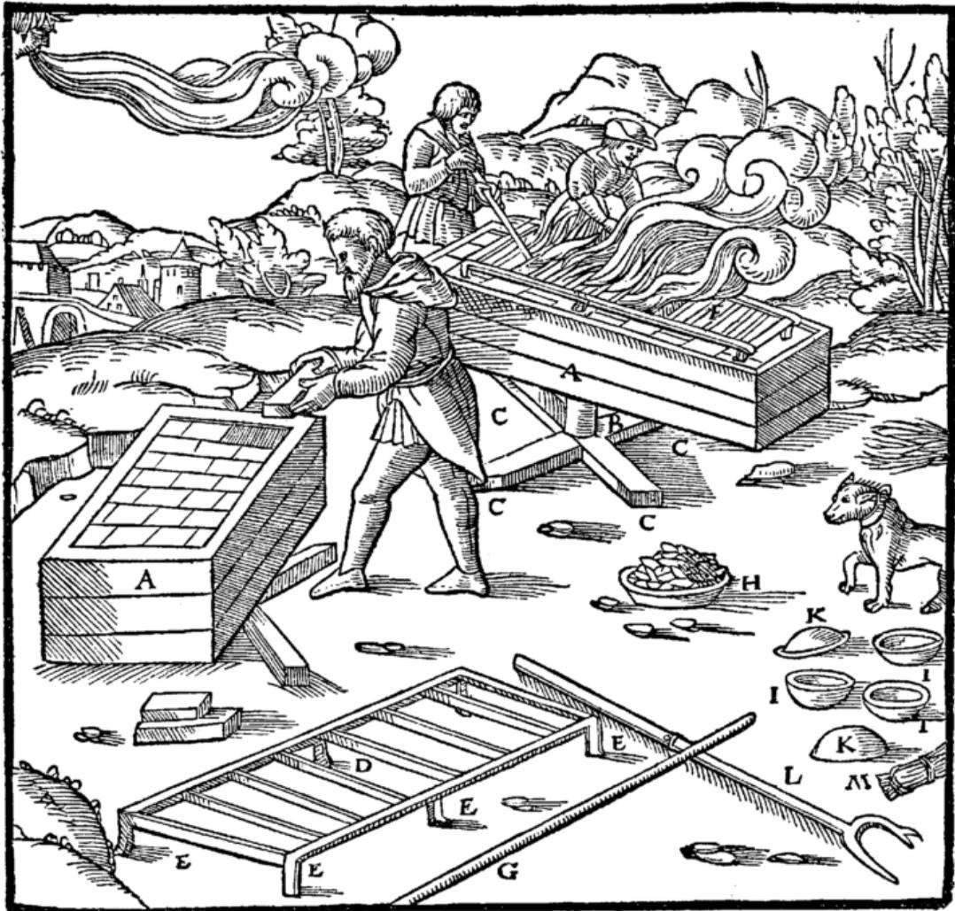
Die Kiste A. Ihre Achse B. Die kreuzweise verbundenen Balken C. Der Rost D. Seine Füße E. Das brennende Holz F. Die Stange G. Die Gußform, in der das Wismut zusammenschmolzen wird H. Kleinere Gußformen I. Metallkuchen K. Die zweizinkige Gabel L. Der Besen M.
