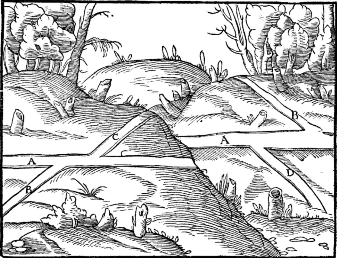
*Der Hauptgang A. Ein Gang, der den Hauptgang schräg schneidet B.
