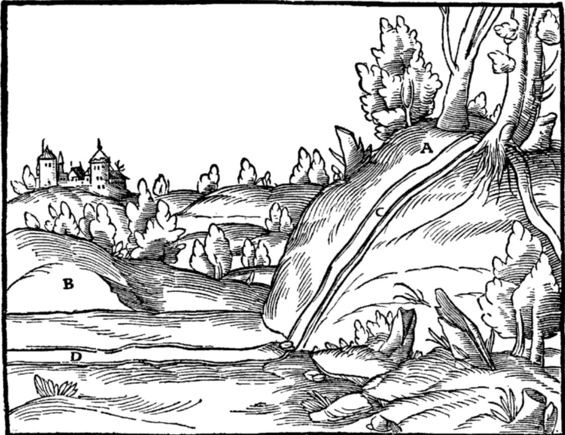
*Das Berggehänge A. Flaches Gelände B. Der Gang C, D.*
