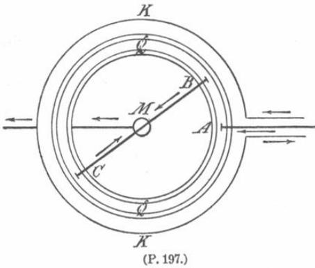
In  $M$  befindet sich eine vertikale Messingsäule, welche oben ein Quecksilbernäpfchen trägt. Dort schwebt auf einer Spitze das Drahtstück  $BC$ . Dieser bewegliche Theil des zweiten Stromkreises wird durch die elektrodynamische Wirkung des Stromes  $K$  in andauernde Rotation versetzt.
