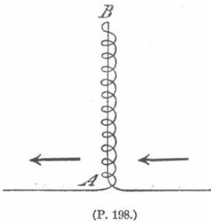
Der Beweis wird in der Weise geführt, dass ein Strom (Fig. 198) zunächst den geraden Draht  $AB$  durchläuft und dann dieselbe Strecke in Windungen zurückgeht. Ein solcher Leiter übt auf die beweglichen Rechtecke keine Wirkung aus.
