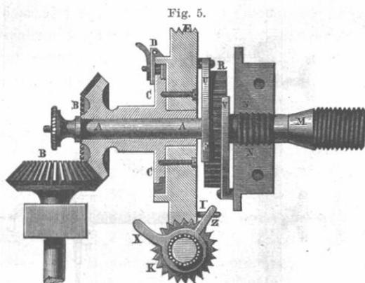
Die Mikrometerschraube *M* liegt (Fig. 5) in dem Lager *NN*, welches in der Zeichnung offengelegt ist, in der sie sich ohne Verrückung dreht; sie verlängert sich dann durch ein Zahnrad *R* und endigt mit der Axe *A*.
