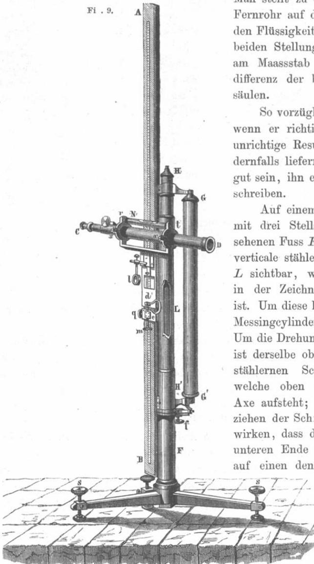
ist nun einerseits der Maassstab *AB* der Axe genau parallel, an der anderen Seite ein den Maassstab als Gegengewicht balancirender massiver Messingcylinder *GG'* befestigt. Der Maassstab besteht aus einem Prisma von Gussstahl, dessen Seiten in einer Breite von 8<sup>mm</sup> möglichst glatt abgehobelt, dann aber stark ausgehöhlt sind. Der Maassstab ist wie das Gegengewicht oben
