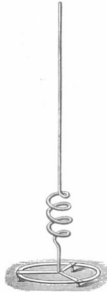
draht gefertigte + Elektrode (Fig. 68 S. 190); ferner der für kupferreiche Lösungen angewendete grössere geschlitzte Konus nebst + Elektrode (Fig. 66 und 67). Aus den Figuren 68 und 69 ist die Zusammenstellung des Apparates ersichtlich.
