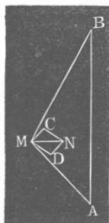
bewegt sich in einer senkrechten Ebene auf den beiden Axen; und da er durch die beiden successiven Drehungen die unendlich kleinen Geraden  $MC$ ,  $CN$  beschreibt, welche senkrecht auf  $MA$ ,  $MB$  und mit den Längen dieser letzten proportional sind, so gelangt er an den Endpunkt  $N$  der Diagonale  $MN$  des aus  $MC$ ,  $MD$  construirten Parallelogramms. Nun sind die Dreiecke  $M CN$ ,  $A MB$  ähnlich wegen eines gleichen Winkels zwischen proportio-
