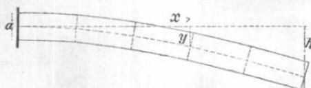
Schicht behält ihre Länge. Es seien, vom Befestigungspunkte an gerechnet,  $x$  die horizontale,  $y$  die vertikale Koordinate eines Punktes dieser „neutralen“ Schicht.  $\epsilon$  ist die Krümmung des Stabes an irgen-
