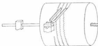
und läßt beide mittels angeklebter leichter biegsamer Spitzen (feine Metallfeder, Streifen aus einer Federspule, geschabtes Celluloid usw.) Sinuskurven in eine dünne Rußschicht schreiben. Die nebeneinander liegenden Wellen werden abgezählt.
