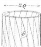
Torsions-Drehmoment eines Kreiszylinders. Man denke sich diesen in dünne konzentrische Röhren zerlegt, von denen eine den inneren und äußeren Halbmesser  $q$  und  $q + dq$  habe. Auf dem Umfange dieser Röhre sei eine vertikale Gerade gezogen. Drehen wir nun den untersten Quer-
