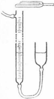
Statt des verschiebbaren Hörrohres vor dem festen Boden kann eine feststehende Höröffnung mit Schlauch und ein verschiebbarer Boden dienen. Eine einfache Anordnung s. Fig., wo das verstellbare Wasserniveau den Boden bildet.
