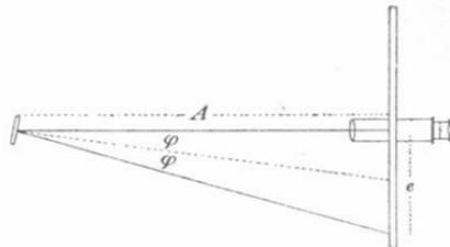
oder von dem Lichtbildchen getroffen wird. Dieser Punkt soll der mittlere Skalenteil heißen. Man findet ihn mit einem rechten Winkel, den man an die Skale so anlegt, daß die Visierlinie längs des anderen Schenkels den Spiegel trifft. — Daß Fernrohr oder Lichtquelle zur Skale symmetrisch stehen, ist unnötig.
