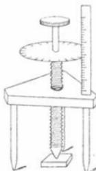
bis zur Berührung einstellt (vgl. unten). Diese Stellung wird abgelesen: die Bruchteile des Schraubenganges auf der mit der Schraube drehbaren geteilten Kreisscheibe, die Ganzen durch Zählen der Umgänge oder an dem Maßstäbchen, an welchem diese Scheibe nahe vorbeistreift.
