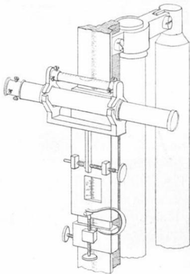
2. Daß die beiden Lagercylinder des Fernrohrs gleich dick sind, wird mit der aufzusetzenden Libelle geprüft, welche dieselbe Einstellung zeigen muß, wenn man das Fernrohr in seinen Lagern umlegt und die Libelle in ihrer alten Lage wieder aufsetzt.
