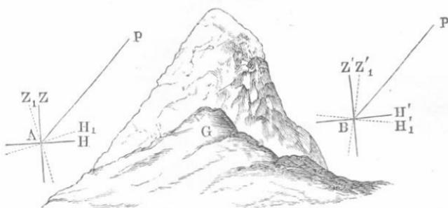
welche darauf beruht, daß man die Anziehung der Erde mit der eines sehr großen Körpers von bekannter Masse vergleicht. Als solcher diene der sich isoliert erhebende Berg Shehallien in Schottland, dessen Volumen und mittlere Dichte angenähert bekannt waren. Die Masse des Berges sei  $m$  und die Masse der Erde  $M = \frac{4}{3} \pi R^3 D$ , wo  $R$  der Radius ist. Die Anziehung des Berges lenkt die Lotrichtungen  $Z$  und  $Z'$  (Fig. 187), die man beobachten würde, falls jene Anziehung nicht
