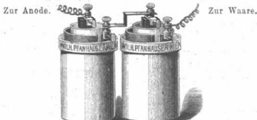
Die **Bunsen-Elemente** verdrängen in den galvanischen Anstalten alle anderen galvanischen Elemente immer mehr und mehr, da sie in der That nicht allein am kräftigsten, sondern auch am constantesten wirken, und sind in denjenigen Fällen, wenn **stundenlange** und **strenge** gearbeitet werden soll, rationell durch keine andere Elementen-Gattung zu ersetzen.
