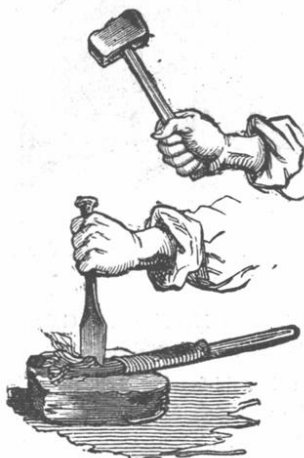
Abhauen der verwickelten Kratzbürstenspitze.
