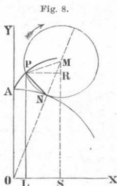
Nimmt man  $b$  und  $\omega$  gleichzeitig negativ, so erhält man die entsprechende Formel für die Hypocycloide.
