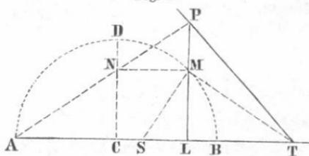
Für die Fläche, deren Basis die Abscisse des oberen Culminationspunktes ist, folgt hieraus der Werth  $\frac{1}{3}\pi a^2$ ; der gesammte Flächeninhalt der Curve ist gleich der Fläche des erzeugenden Kreises.
