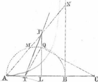
durch  $A$  zieht man eine beliebige Gerade, welche den Kreis in  $M$ , die Tangente in  $N$  schneidet und nimmt die Strecke  $AP=MN$ . Alle so entstandenen Punkte  $P$  bilden eine Curve, deren Gleichung lautet
