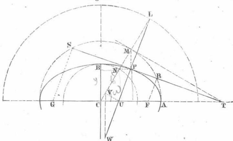
Punkt der  $x$ -Achse, was eine einfache Tangentenconstruction giebt. Die Tangente halbirte den Nebenwinkel des von den Brennstrahlen  $FPG$  und  $GP$  gebildeten Winkels  $FPG$ . Fällt man von den Brennpunkten Senkrechte auf die Tangente, so liegen die Fusspunkte  $R$  und  $S$  dieser Perpendikel auf dem umschriebenen Kreise.
