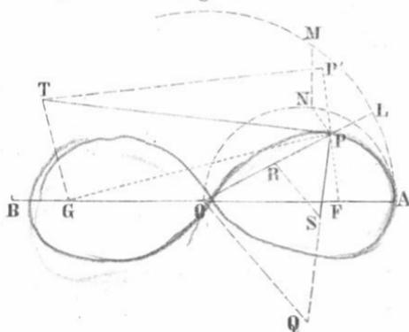
$FP'$ ; diese Senkrechte schneidet die in  $G$  auf dem andern Brennstrahle  $GP$  errichtete Senkrechte in einem Punkte  $T$ , welcher der gesuchten Tangente angehört. Nimmt man auf der Normale die Strecke  $PQ = a$ , auf dem Radiusvector die Strecke  $PR = \frac{1}{3}a$  und zieht durch  $R$  eine zu  $OQ$  parallele Gerade, so schneidet letztere die Normale im Krümmungsmittelpunkte  $S$ .
