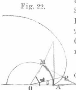
eine Tangente gelegt und auf derselben eine Strecke  $MP$  abgeschnitten, welche gleich ist dem Kreisbogen zwischen  $M$  und einem festen Punkte  $A$ ; alle so construirten Punkte  $P$  bilden eine Curve, welche sich für  $\angle AOM = \omega$  folgendermassen ausdrücken lässt
