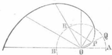
sei nun wieder  $OA = a$  und die Peripherie des um  $O$  mit dem Radius  $a$  beschriebenen Kreises eben so wie vorhin getheilt; nach den Theilpunkten zieht man die Radien und trägt auf letztere, vom Mittelpunkte  $O$  aus, die entsprechenden geradlinigen Strecken auf, so dass immer  $OP = arc\ AQ$  ist. Die Gleichung der Spirale ist hiernach
