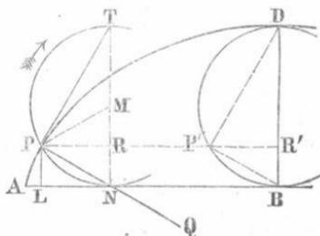
Parallele, durch  $N$  eine Senkrechte zu  $AB$  und trägt von dem Durchschnitte  $R$  beider Linien die Strecke  $RP = R'P'$  ab. Nimmt man  $A$  zum Anfang rechtwinkliger Coordinaten,  $AB$  zur Abscissenachse, setzt den Kreisradius  $MP = b$  und den sogenannten Wälzungswinkel  $PMN = \omega$ , so erhält man
