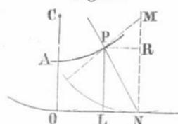
Ist nämlich  $c < b$  wie in Fig. 25, so heisst die Curve eine gedehnte Cycloide. Dieselbe schneidet die Abscissenachse nicht und besitzt an den Stellen  $x=0, \pm \pi b, \pm 2\pi b, \pm 3\pi b$ , etc. Culminationspunkte, welche abwechselnd untere und obere Culminationspunkte sind; dazwischen liegen Inflexionspunkte, deren  $\omega$  durch die Gleichung  $\cos \omega = \frac{c}{b}$  bestimmt werden, deren Abscissen mithin sind
