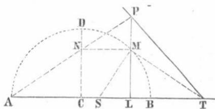
die Gerade  $AN$ , welche der nöthigenfalls verlängerten  $LM$  in  $P$  begegnet. Alle hiernach construirten Punkte  $P$  liegen in einer Curve, welche für  $CL=x$ ,  $LP=y$  durch die Gleichung
