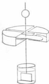
Genauere Orientirung. Man dreht die Nadel mittels der Aufhängung so, daß der bei abgeleiteten Quadranten unter Anlegung eines hohen Potentials an die Nadel eintretende Ausschlag ein Minimum wird,
