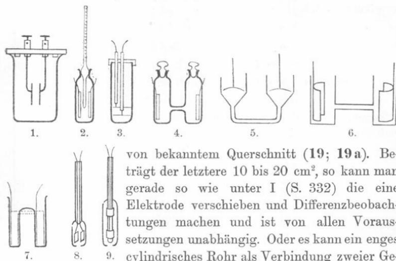
von bekanntem Querschnitt (**19; 19a**). Beträgt der letztere 10 bis 20 cm<sup>2</sup>, so kann man gerade so wie unter I (S. 332) die eine Elektrode verschieben und Differenzbeobachtungen machen und ist von allen Voraussetzungen unabhängig. Oder es kann ein enges cylindrisches Rohr als Verbindung zweier Gefäße, in denen die Elektroden stehen, angebracht sein, ähnlich wie Fig. 6. Dann ist zu der Widerstandskapazität des Rohres die Ausbreitung in die Gefäße hinzuzufügen (S. 280).
