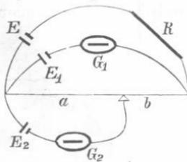
Stöpselrheostaten. Solche kann man in IV, V und VI für die Widerstände  $a+b$  nehmen, indem man die Drähte von  $E$  fest an die Enden des Rheostaten bringt, mit den Drähten von  $e$  und  $G$  dagegen die beiden Seiten einer solchen Widerstandsstrecke  $a$  berührt, daß der Strom in  $G$  verschwindet.
