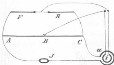
$J$  bedeutet den Erzeuger der Wechselströme,  $a$  die äußere,  $i$  die innere Rolle des Dynamometers,  $F$  den Flüssigkeitswiderstand,  $R$  den Rheostatenwiderstand, je nach Bedürfnis zwischen 10 und 1000 Ohm. Die Strecke  $ABC$  soll die Verzweigungswiderstände bedeuten, entweder einen Draht mit Schleifkontakt oder zwei konstante Widerstände (vgl. 71 b).
