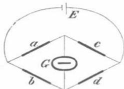
meter. Die Widerstände werden so abgeglichen, daß in  $G$  kein Strom, also daß  $a:b = c:d$  ist. Die Nadel des Instrumentes im Hauptstrom zeige die Ablenkung  $\varphi$ . Der Hauptstrom wird unterbrochen. Durch den dabei in  $a$  entstehenden Extrastrom
