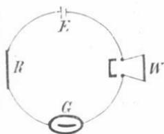
Der zu bestimmende Widerstand  $W$  ist in der Zeichnung eingeschaltet, kann aber, etwa durch Herstellung einer widerstands-freien Nebenschließung (die gewöhnlichen Stromschlüssel sind oft unzuverlässig), ausgeschaltet werden. Zuerst wird die Einstellung der Galvanoskopnadel beobachtet,
