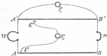
Der Widerstand  $W$  ist gleich einem Bruchteil, etwa  $\frac{1}{10}$  oder  $\frac{1}{20}$  von  $AB$ ;  $w$  bedeutet einen Bügel von dickem Kupferdraht.  $W$  und  $w$  lassen sich widerstandsfrei auswechseln.
