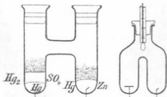
Am gebräuchlichsten ist die H-Form (Lord Rayleigh; Fig. Daneben eine abgeänderte Form mit Glasstöpselverschluss).
