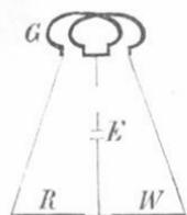
Draht den anderen Strom in entgegengesetzter Richtung, so bleibt die Nadel in Ruhe, wenn die Ströme gleich sind.
