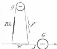
der gesuchte Widerstand gleich  $\frac{P}{J - P/\gamma}$  Ohm. Diese Methode unterscheidet sich von Nr. 1 eigentlich nur durch den Namen Spannungsmesser.
