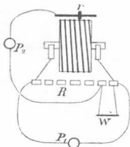
Zusatzwiderstände. Die Genauigkeit lässt sich durch Anschaltung von Widerständen erhöhen, die zur Bequemlichkeit der Rechnung passende Vielfache des Drahtwiderstandes sind. Um die Genauigkeit bei Vergleichen in der Gegend von 1:1 sowie 1:10 zu verzehnfachen, genügen z. B. 2 Widerstände von je 4,5mal dem Drahtwiderstand, welche man entweder beiderseitig oder beide einseitig zuschaltet. Vgl. F. K. Wied. Ann. 56, 177. 1895.
