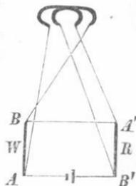
Ausschlag werde jetzt Null, wenn  $W$  und  $R_2$  eingeschaltet werden, so ist  $W = \frac{1}{2}(R_1 + R_2)$ .
