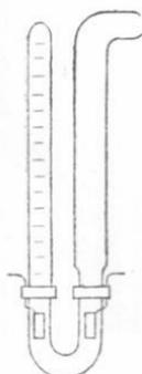
Bei schwachen Strömen ist, weil der Sauerstoff infolge von Ozonbildung teilweise vom Wasser absorbiert wird, nur das entwickelte Wasserstoffgas aufzufangen und durch Multiplikation mit  $\frac{3}{2}$  das Volumen des Knallgases zu berechnen. Das neben gezeichnete Voltmeter läßt den getheilten Schenkel durch bloßes Umkehren wieder mit der Flüssigkeit anfüllen.
