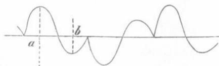
eingebüßt worden ist, Zurückwerfung ein. Nun läßt man abermals zweimal umkehren und wirft bei der nächsten Erreichung der Gleichgewichtslage wieder zurück, u. s. f. Schliesslich nehmen die Ausschläge der Nadel konstante Werte an. Dann herrschen also Schwingungen von der in der Figur graphisch dargestellten
