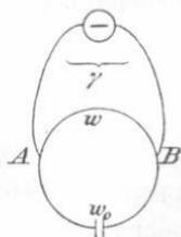
Sind die übrigen Widerstände gegen  $\gamma$  nicht zu vernachlässigen, so kommt eine Korrektion hinzu. Es sei  $w$  der Widerstand der Hauptleitung zwischen den beiden Punkten,  $w_0$  ihr übriger Widerstand einschliesslich der Stromquelle, so war die Spannung  $P'$  vor dem Anlegen des Zweiges gleich
