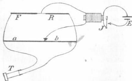
metallische Widerstände anwendbar. Man verbindet die inducirte Rolle des Induktionsapparates  $J$  so, wie in der Figur, mit dem Flüssigkeitswiderstand  $F$ , dem bekannten Widerstande  $R$  und dem Schleifkontakt des Brückendrahtes  $ab$ .
