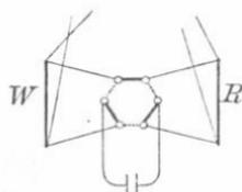
Zum Auswechseln dient ein sechsnäpfiger Kommutator, dessen Quecksilbernäpfe durch drei Kupferbügel paarweise verbunden werden, entweder so, wie die ausgezogenen oder so, wie die punktierten Linien angeben.
