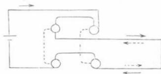
Den einfachsten Stromwender gibt ein Brett mit vier Quecksilbernäpfen 1 2, von denen man durch ein Paar von Metallbügeln entweder 1 mit 2 und 3 mit 4 verbinden kann oder 1 mit 3 und 2 mit 4. Zu 2 und 3 führt man die
