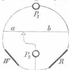
Punkten die Säule, welcher das Galvanoskop enthält. Unter Umständen kann die Empfindlichkeit in dem einen oder anderen Falle größer sein. Bringt man die Säule nach  $P_2$ , so funktioniert der Schleifkontakt sicherer, was eine große Annehmlichkeit beim Arbeiten ist. Fehler von einer Erwärmung des Drahtes durch den Strom werden bei der anderen Anordnung leichter vermieden.
