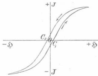
Als Maß der Koercitivkraft betrachtet man die Intensität  $OC_1$  oder  $OC_2$  (Fig.), welche in einem Stabe, der ganz ruhig gehalten wird, nach einer Magnetisierung in der anderen Richtung den unmagnetischen Zustand herstellt. Bei weichem Eisen etwa  $= 2$ , steigt sie für gehärteten Wolframstahl auf etwa 50–70.
