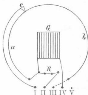
1. Sinusbussole. Man verbindet die Klemmen II (oder V) und IV mit der Leitung. Mittels  $R$  kann man zugleich einen Widerstand einschalten. Als Teilkreis dient die Gradeinteilung am Brückendraht. Vgl. 65.
