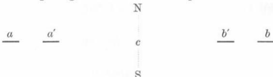
der magnetische Meridian. Der Magnet wird folgeweise in den gezeichneten Lagen östlich oder westlich von der Nadel in der Höhe der letzteren hingelegt. Die Abstände der Magnetmitte vom Centrum der Bussole sind paarweise gleich,  $ac = bc$ ,  $a'c = b'c$ .
