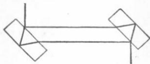
In den Weg der beiden Strahlen zwischen den Platten mögen zwei optisch gleiche Körper geschoben sein. Nimmt man nun an dem Wege des einen Strahles Änderungen vor, etwa bezüglich Temperatur, Druck, Konzentration etc., während man die Streifen im Auge behält, so wandern dieselben. Aus ihrer Verschiebung, der Länge der eingeschalteten Körper und der Wellenlänge des Lichtes läßt sich die der Zustandsänderung entsprechende Änderung des Brechungsindex bestimmen (II).
