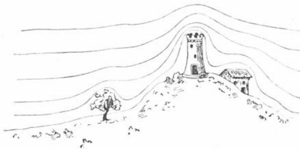
Schematische Darstellung der durch Unebenheiten der Erdoberfläche gestörten Niveauflächen des luft-elektrischen Potentials.
