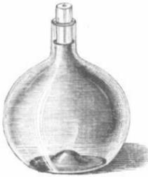
Andere Formen des Gefässes kommen manchmal noch in Anwendung. Die in Fig. 296 dargestellte eignet sich sehr gut für zerkleinerte feste Körper; die Form Fig. 297 (wo eine aufgeschliffene Glasplatte die Stelle des Glasstöpsels vertritt) dient häufig für Mineralien, von welchen oft ein einzelner
