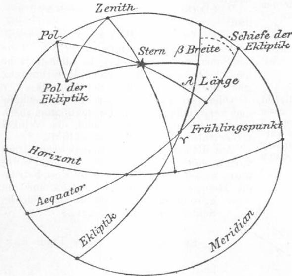
**Erkl. 105.** Auf der Figur 66 sind die drei Koordinatensysteme des Horizonts, des Aequators und der Ekliptik zusammengestellt.
