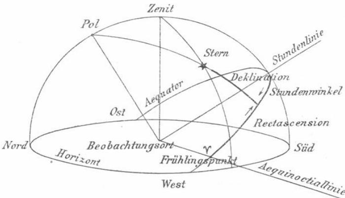
Die Koordinate des Parallelkreises führt den Namen Deklination (Abweichung). Sie wird mit  $\delta$  bezeichnet und vom
