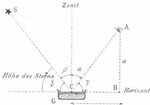
**Erkl. 17.** Die so auf diese Weise bestimmte Höhe ist indessen die scheinbare Höhe, d. h. die infolge der Refraktion veränderte. Will man die wahre Höhe haben, so muss man von dieser Höhe den durch die Refraktion entstandenen Fehler subtrahieren.
