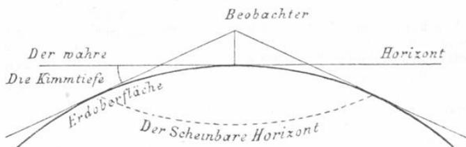
**Frage 6.** Wie findet man die Grösse des Horizonts für eine bestimmte Höhe über der Oberfläche der als kugelförmig gedachten Erde?
