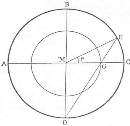
Winkel  $CME$  gleich dem gegebenen sphärischen Abstände  $\varphi$  und verbinde  $E$  mit dem Punkte  $O$ . Die Verbindende schneidet den Halbmesser  $MC$  in  $G$ . Die Länge  $MG$  ist dann der gesuchte Radius des Projektionskreises. Von dieser Konstruktion wird in der sogenannten Polarprojektion der Erdkugel Gebrauch gemacht.
