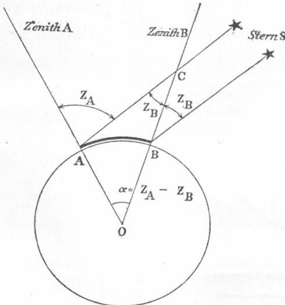
**Antwort.** Das Prinzip der arabischen Messung ist dasselbe, welches auch heutzutage benützt wird. Man mass an einem Orte A die Zenithdistanz eines bekannten Sternes  $Z_A$  und zu gleicher Zeit auch an einem andern Orte, der genau in südlicher Richtung vom ersten lag, die Zenithdistanz  $Z_B$  desselben Sternes. Sodann war der:
