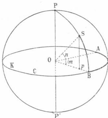
Man legt durch den Mittelpunkt ( $O$  in der Figur 1) der Kugel eine Ebene, welche die Kugel in einem sogenannten grössten Kreis  $K$  schneiden wird. Diese Ebene heisst die Fundamentelebene. Die im Mittelpunkt der Kugel auf die Fundamentelebene errichtete Senkrechte schneidet die Kugeloberfläche in zwei Punkten ( $P$  und  $P'$ ), die man Pole nennt.
