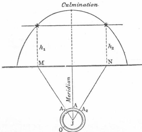
Antwort. Um die Richtung des Meridians zu bestimmen, bestimme man das Azimut eines terrestrischen Objektes, wie im vorhergehenden Falle und drehe das Fernrohr von  $A_1$  der Kreisteilung um den Winkel  $\alpha + u$  bis zu  $A_3$  (Figur 33). Die Visur gibt dann die Richtung des Meridians. Man kann auf diese Weise immer unabhängig von einer Sternbeobachtung die Richtung des Meridians finden.
