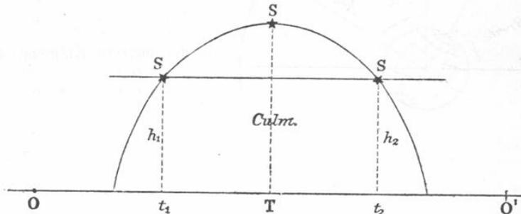
**Frage 39.** Wie bestimmt man die Korrektion der Uhr durch korrespondierende Fixsternhöhen?
