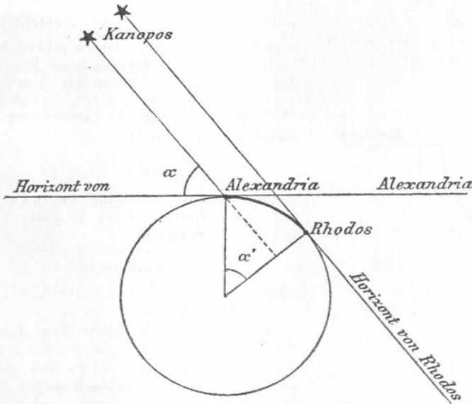
**Antwort.** Posidonius bemerkte, dass in Rhodos der Stern Kanopos im Schiff Argo gerade zur Zeit, wo er in Rhodos den Horizont berührte, in Alexandrien  $\frac{1}{48}$  der Kreisperipherie über dem Horizont stehe und da er nun die Entfernung dieser beiden Städte zu 5000 schätzte, fand er den Erdumfang zu:
