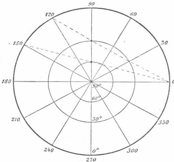
Die Meridiane sind nach der Frage 61. 2) gerade Linien, die sich im Mittelpunkte des Kreises schneiden. Die Parallelkreise sind nach der Frage 62 zu konstruieren. Figur 52 gibt diese Konstruktion von  $30^\circ$  zu  $30^\circ$  mit den notwendigen Hilfslinien.
