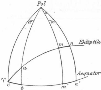
dem Grunde, weil die Ebene des Aequators gegen jene der Ekliptik unter einem Winkel von ungefähr  $23\frac{1}{2}^{\circ}$  geneigt ist. (Man nennt diesen Winkel die Schiefe der Ekliptik und bezeichnet ihn mit  $\epsilon$ , vergl. den Abschnitt F.) Um dieses einzusehen, betrachten wir die Figur 24. Hier wird offenbar:
