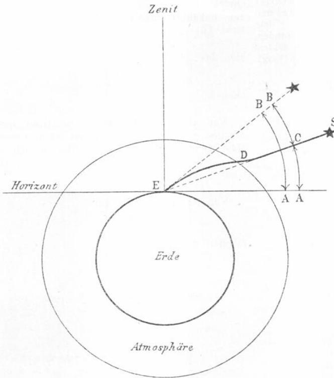
beiden Richtungen, also der Winkel  $BEC$  bildet die sogenannte Korrektion wegen Refraktion. Beobachtet man die Höhe des Sternes  $S$ , so gibt die Beobachtung den Winkel  $AEB$ . Wird von diesem die Korrektion wegen Refraktion, also der Winkel  $BEC$  abgezogen, so erhält man die wahre Höhe  $AEC$ .
