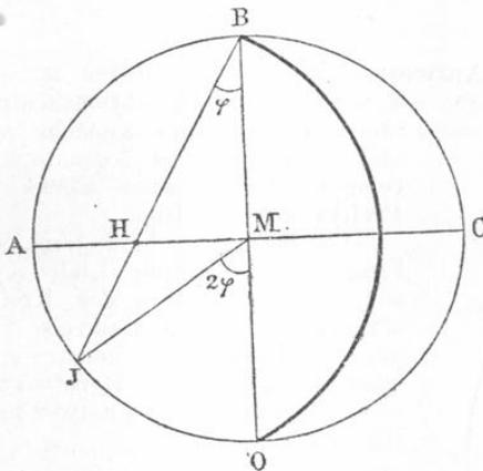
**Frage 65.** Wie findet man die Projektion eines Kugelkreises, der auf der Projektionsebene senkrecht steht und diese längs einer gegebenen Linie schneidet?
