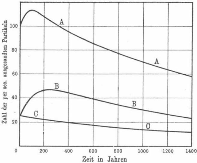
AA und BB stellen die Zahl von  $\alpha$ - bzw.  $\beta$ -Partikeln dar, die in der Sekunde von Radium ausgesandt werden, CC die Zahl der in der Sekunde zerfallenden Atome.
