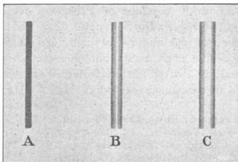
Elektrostatische Ablenkung der  $\alpha$ -Strahlen. Dreifache Vergrößerung.
