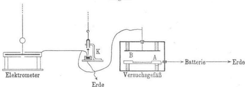
Versuchsanordnung für Aktivitätsbestimmungen mit Hilfe des Elektrometers.
