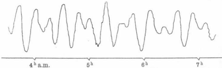
Interferenz von Grund- und Oberschwingung (Kempfenhausener Limmimeter, 25. August 1900).
