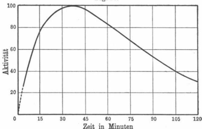
Änderung der  $\beta$ -Strahlenaktivität eines Drahtes, der für kurze Zeit der Radiumemanation exponiert worden ist.
