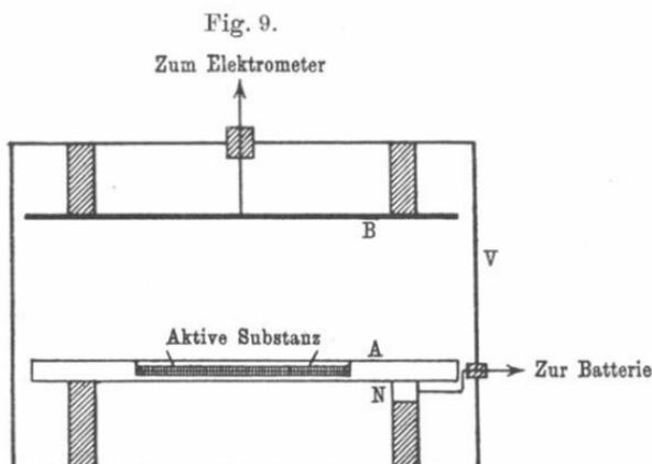
Versuchsgefäß mit parallelen Plattenelektroden.
