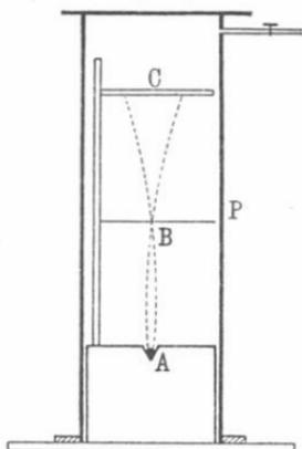
Versuchsanordnung zur Messung der Ablenkung eines Bündels von  $\alpha$ -Strahlen im magnetischen Felde.
