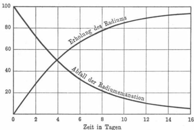
Abfallskurve der Radiumemanation und Erholungskurve des Radiums nach Messungen der  $\alpha$ -Strahlenaktivität; für die Erholungskurve ist das Minimum von 25 Proz. als Null angesetzt.
