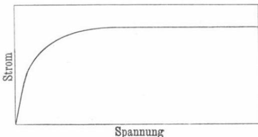
Typische Kurve für den Sättigungsstrom in einem ionisierten Gase.
