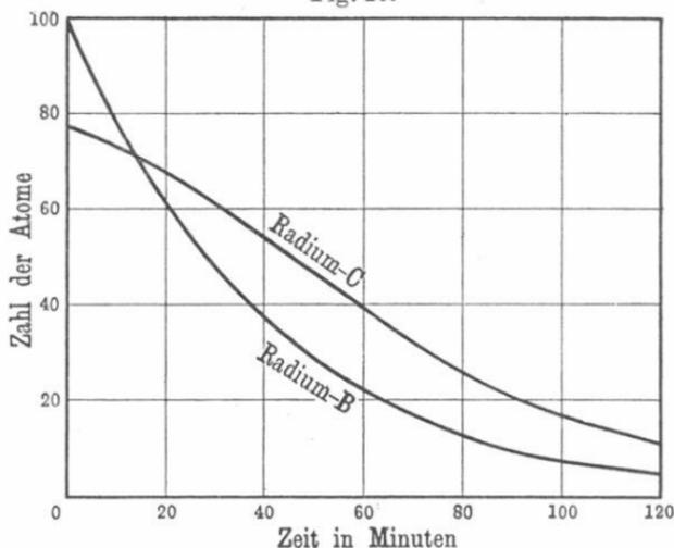
Änderung, die die Zahl der Atome von Radium-B und Radium-C theoretisch erfährt, wenn die aktive Substanz anfänglich aus Radium-B und Radium-C im Gleichgewicht besteht.
