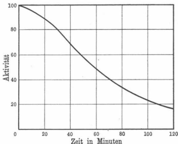
Änderung der  $\beta$ - oder  $\gamma$ -Strahlenaktivität eines Drahtes, der für eine lange Zeit der Radiumemanation exponiert worden ist.
