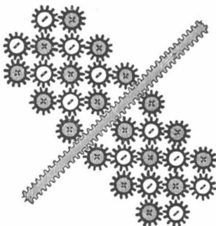
Fig. 39. — Vorläufige Darstellung eines Stroms, der ein umgebendes Dielektricum entweder treibt oder von ihm getrieben wird. Längsschnitt des Drahts. Vergl. Fig. 30B.
