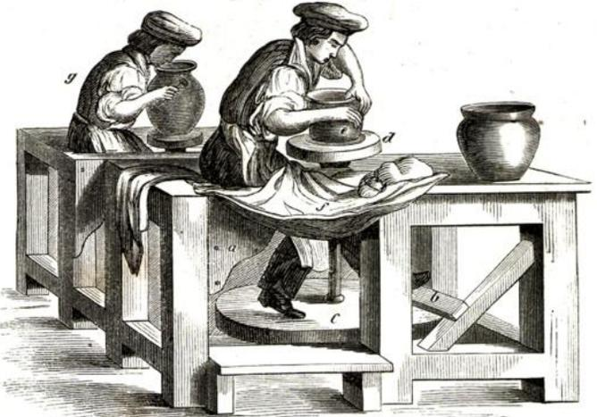
Die ganze Vorrichtung ist in Fig. 1222 mit dem arbeitenden Töpfer gezeichnet. *a* ist das Sitzbrett, *b* das Fußbrett, *c* die Tretscheibe, *d* die Drehscheibe, *e* das Arbeitsstück, *f* sein Thonvorrath, der auf einem feuchten Tuche liegt.
